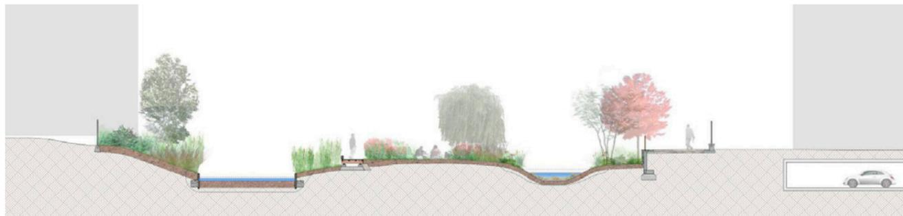
Profil sur le plan d'eau et noues - © V.Pruvost
