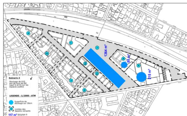
Différents scénarii de stockage des eaux pluviales
